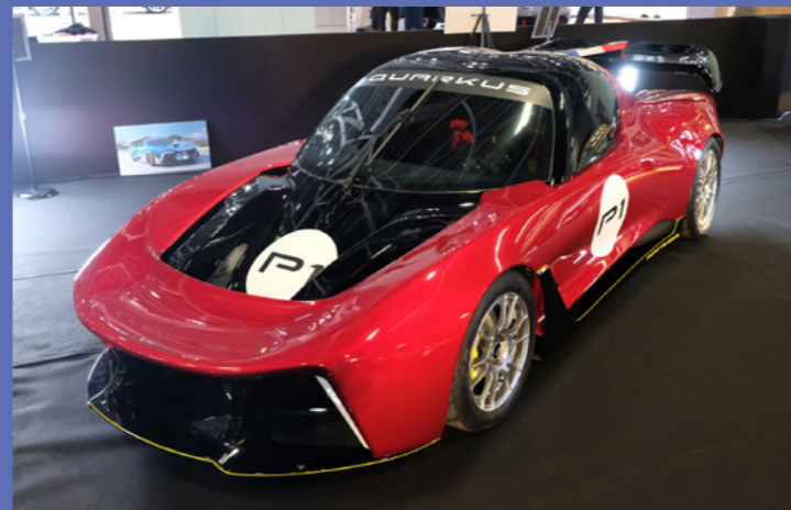
Construit en kevlar, carbone et aluminium, le prototype Quarkus P1 affiche un poids de 550 kg seulement pour une puissance de 250/300 ch. Son moteur de moto est un quatre cylindres de 1 000 cm 3 à compresseur en position centrale-arrière, fonctionnant au Superéthanol E85. Dix clients se sont manifestés pour participer au développement de la version P2 qui sera homologuée pour la route et dont le prix devrait se situer entre 150 000 € et 200 000 €.
