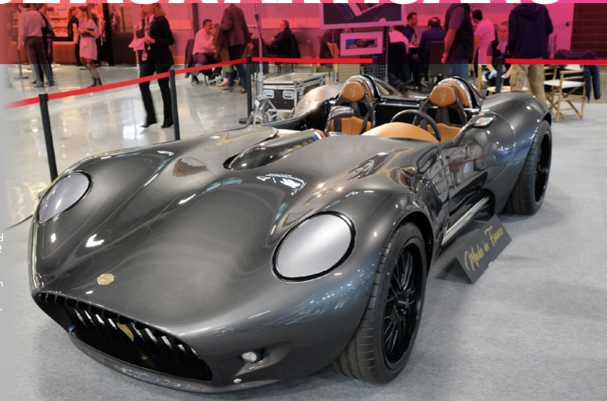
A 69 ans, le Toulousain José Cabrerizo a mis sept ans pour achever cette auto évoquant les grandes heures des roadsters. Large, racée, la Babiéca en reprend les ingrédients : un gros moteur V12 6 litres sur base Mercedes de 550 ch à l'avant, une boîte Tremec 6 vitesses et un pont arrière de Nissan GTR. Avec un châssis tubulaire en acier et une carrosserie en carbone, fibre et aluminium, cet exemplaire unique et non homologué pèse 1245 kg.
